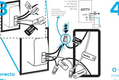
Conecta L al cable de Corriente. Empalmar los cables neutros. Cada RL tiene dos cables, conecta uno a la carga y el otro al cable de corriente. Si tienes una toma de tierra, déjala dentro del cajetín.
