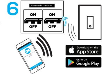
Activa la corriente en el interruptor automático/ fusible. Descarga la aplicación de smartphone iotty y registrate. Conéctate a la wifi de Interruptor Inteligente iotty [IOTTY\_número\_de\_serie]. Ahora navega a la aplicación y seleccione la opción de añadir un dispositivo nuevo.
