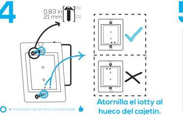
ntenta empujar todos los cables dentro del cajetín de la pared y deja tanto espacio como puedas para el interruptor. (No empujes el cableado con la parte de atrás del interruptor.) Inserta el Interruptor inteligente iotty en el cajetín de la pared, ajustando con los tornillos. Ubica el interruptor para que los botones queden orientados hacia abajo.
