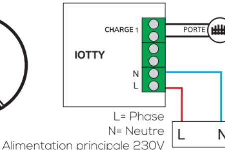
Pour affecter l'interrupteur correctement, accédez à l'application iotty, aller dans Paramètres du périphérique et sous "Type de groupe" sélectionnez «Gate/Porte».
