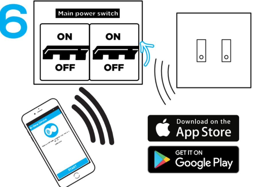
Activa la corriente en el interruptor automático/fusible. Descarga la aplicación de smartphone iotty y regístrate. Conéctate a la wifi de Interruptor Inteligente iotty [IOTTY\_número\_de\_serie]. Ahora navega a la aplicación y seleccione la opción de añadir un dispositivo nuevo.
