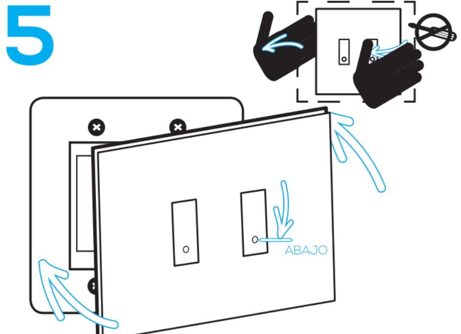
**Inserta la cubierta del interruptor al iotty.** Para desencajar la tapa, levanta la cubierta con las manos. Ubica la tapa haciendo que el círculo pequeño se encuentra hacia abajo.
